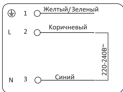
Вариант подключения для однофазной сети
